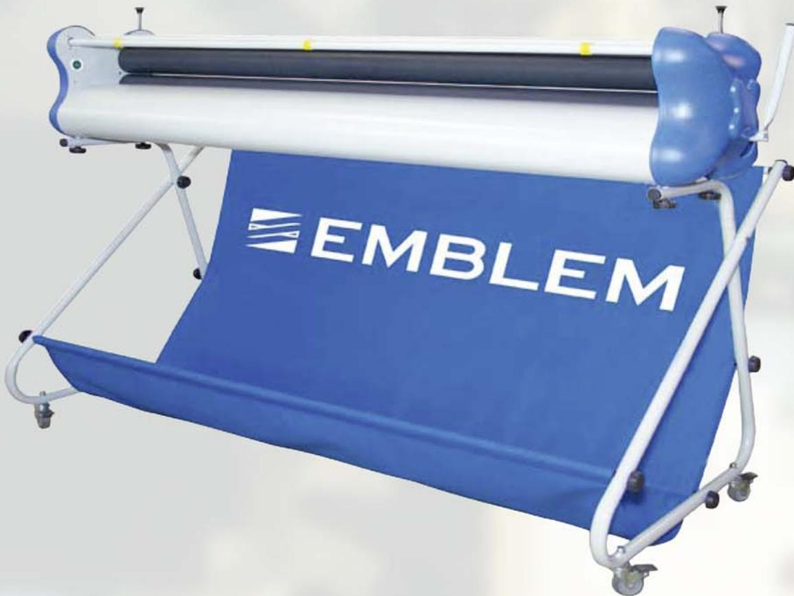
Der **EMBLEM EASYLAM junior III** ist ein groß-formatiger Kaltlaminator, der ein Laminieren bzw. Kaschieren beliebigen Materials bis zu einer Maximalbreite von 1400 mm ermöglicht. Die Gummiandruckwalzen mit einem Durchmesser von 80mm können bis zu 30mm geöffnet werden, was eine Vielzahl zu laminierender bzw. kaschierender Materialien zulässt.
